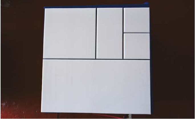
Панель ЭхоКор раскроена для укладки с зазором 10 мм
